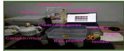
Gambar 1. Perlengkapan Teknik Decal Dekorasi Keramik
