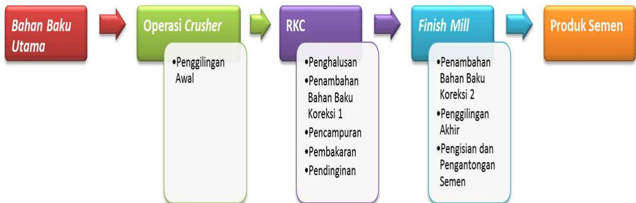
Gambar 1 Diagram Alir Proses Produksi Semen PT X
