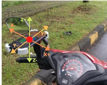
**Gambar 6.** Instalasi Smartphone pada kendaraan bermotor
